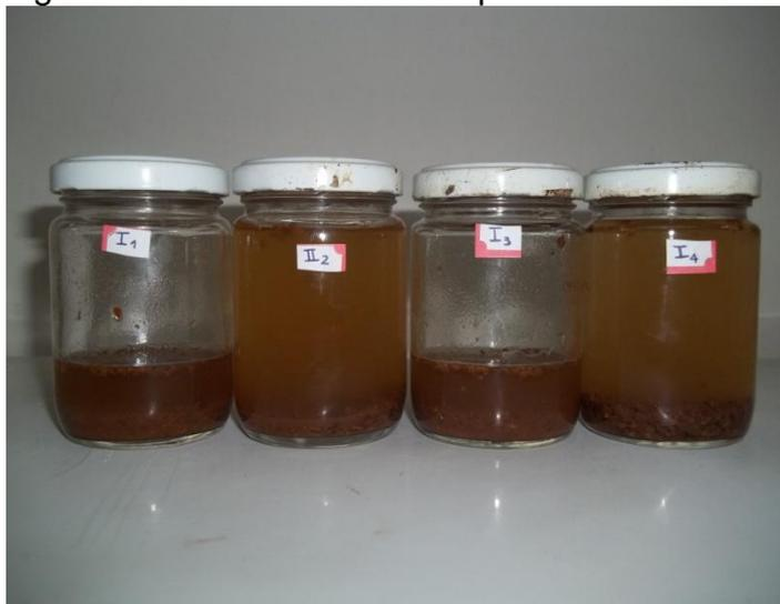
Os estudos da hidrólise ácida das tortas de tucumã e inajá, empregando ácido sulfúrico como catalisador, foram realizados primeiramente em função da temperatura. A concentração do ácido sulfúrico foi mantida em 0,25 M, enquanto foram usadas temperaturas de 100 e 120°C. A razão sólido-líquido também foi inicialmente mantida em 1:10 (m/v). Aproximadamente 5 g de cada torta foram colocados nos vidros juntamente com 50 mL de ácido sulfúrico.
