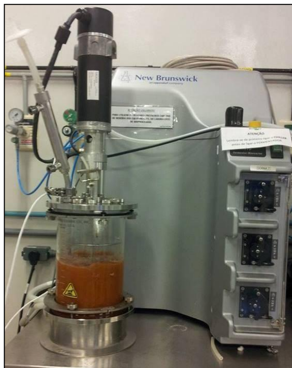
Figura 13: Bioreator- Extração por maceração enzimática em escala piloto.
