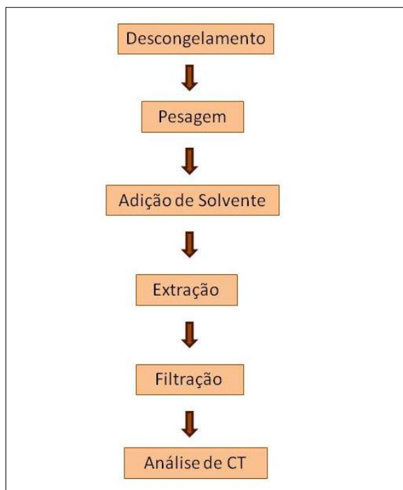
Figura10: Fluxograma do processo de extração de carotenoides por Ultrassom.
