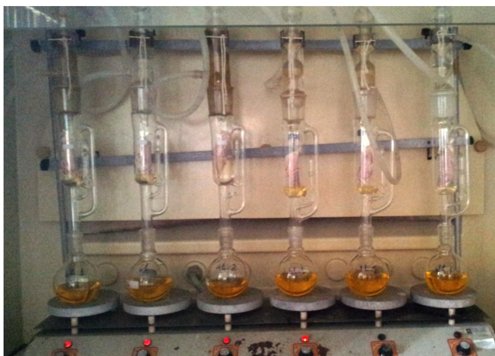
Figura 17: Extração via Solventes utilizando Hexano
