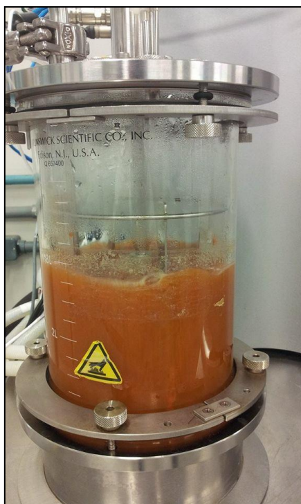
Figura 20: Extração por Maceração enzimática em escala piloto.
