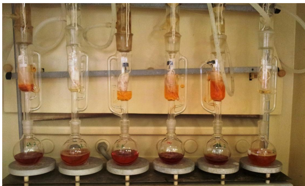
Figura 16: Extração via Solventes utilizando Etanol
